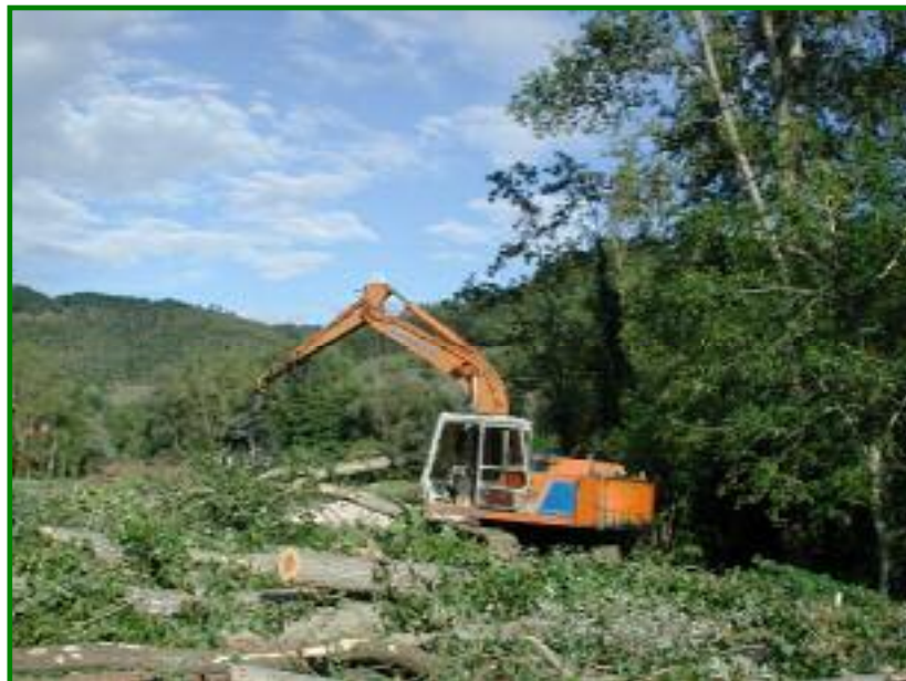
Foto 4 - L'escavatore effettua una parziale sramatura e sezionatura delle piante più voluminose ed eventualmente anche una prima selezione
