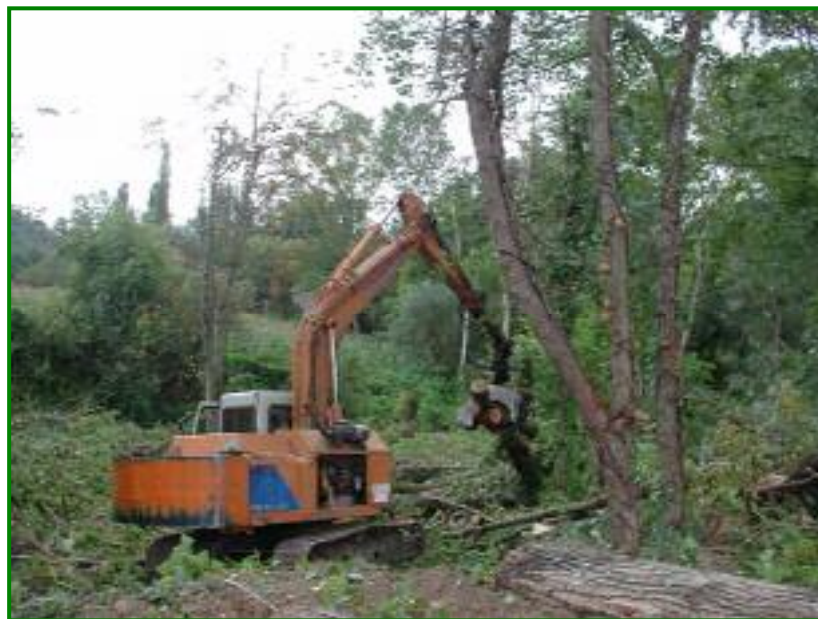
Foto 2 - L'escavatore può effettuare anche la movimentazione del legname abbattuto
